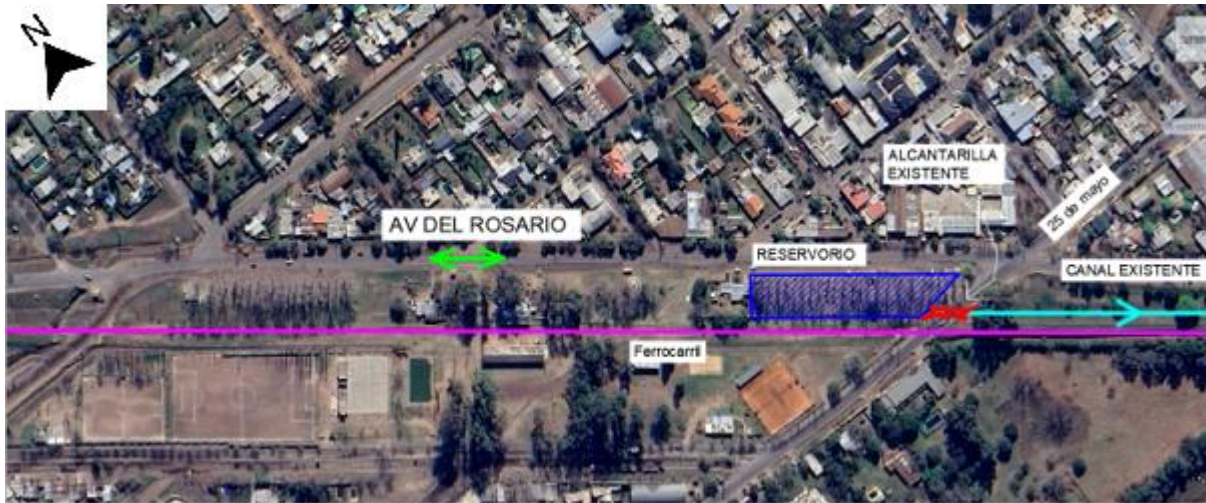
Figura 21 - Alcantarillas y canales existentes (Fuente: Google Maps)
