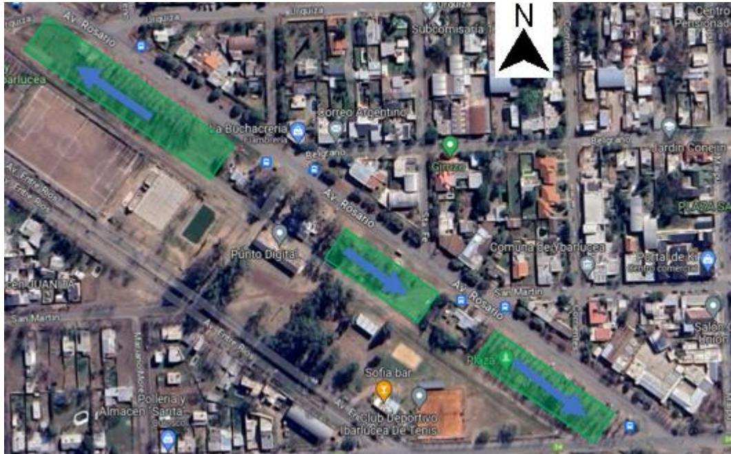
Figura 34 - Sectores de escurrimiento mantiforme (Fuente: Google Maps)
