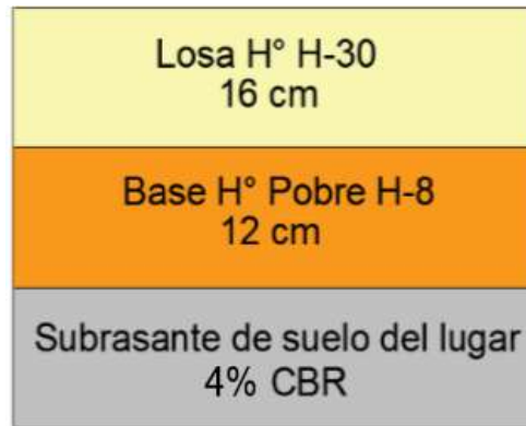
Figura 6.2 - Esquema paquete estructural adoptado para pavimento rígido de dársena.
