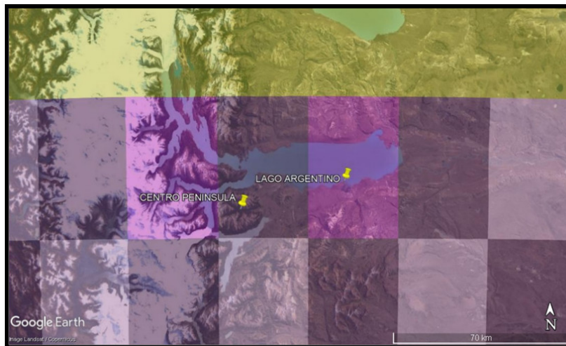
Figura 6.52: Diferencias, en la comparación de áreas de polígonos de Thiessen y PERSIANN. La primera de 49624 km 2 y la segunda, más pequeña de 1000 km 2 , píxeles en amarillo y rojo, reflejan el mayor detalle que aporta el sistema PERSIANN.
