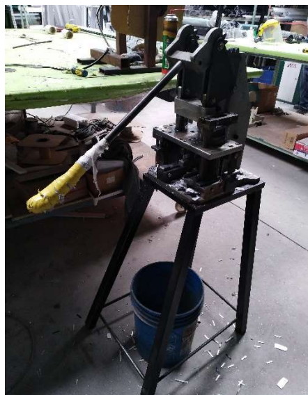
Fig. 30. Punzonadora con protección de goma espuma casera.
