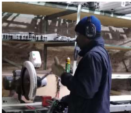
Fig.124. Operario en puesto de corte, utilizando protector auditivo de copa.
