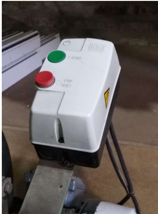
Fig. 31. Dispositivo de parada de emergencia de la sierra circular
