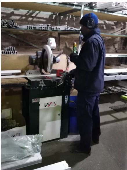
Fig. 51. Puesto de corte con sus EPP reglamentarios
