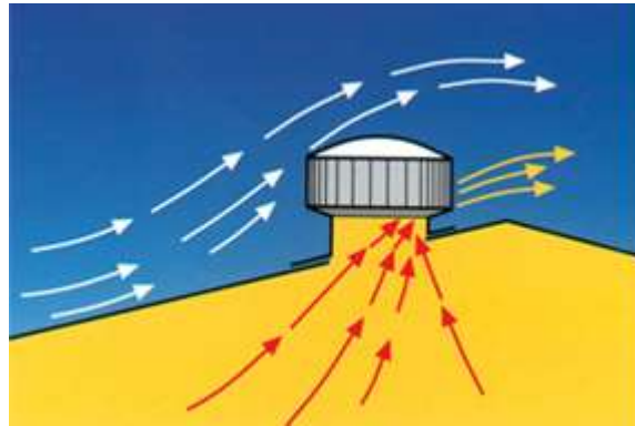
Fig. 94. Funcionamiento extractor eólico con viento
