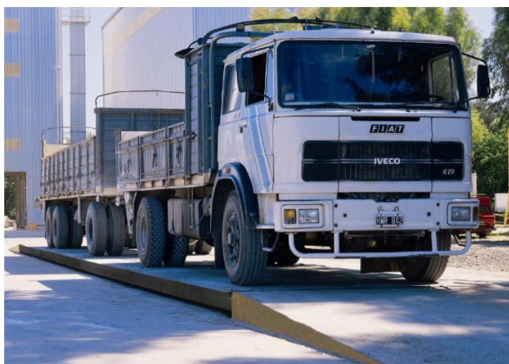
Ilustración 49: Balanza para pesaje de camiones recolectores “Moretti 7500” (fuente: página web oficial de Moretti)
