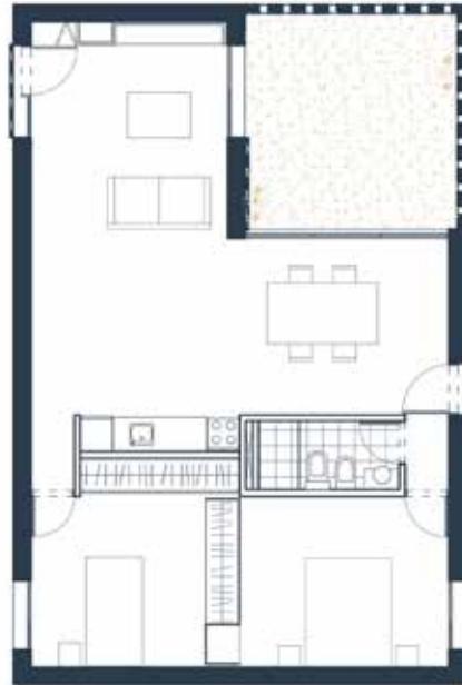
Planta unidad 01 65 m2 cubiertos 15 m2 patio
