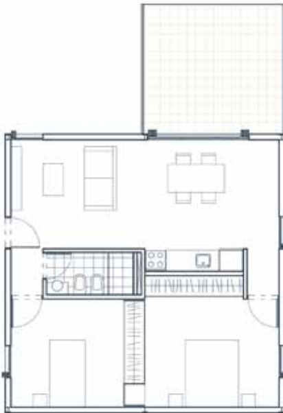
Planta unidad 03 60 m 2 cubiertos 15 m 2 patio
