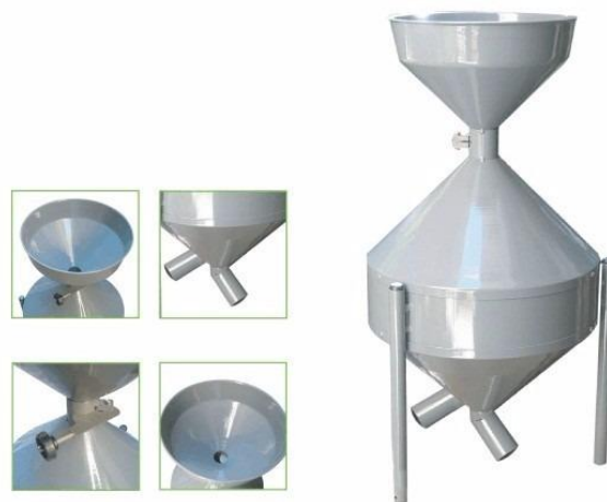
Figura 6. Detalles exterior e interior de homogeneizador de semillas tipo Boerner.
