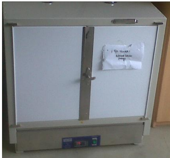
Figura 8. Imagen de la estufa donde se realizó el test de envejecimiento acelerado
