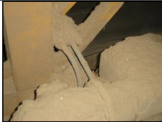
Figura 25. Motor eléctrico tapado totalmente con polvo.
