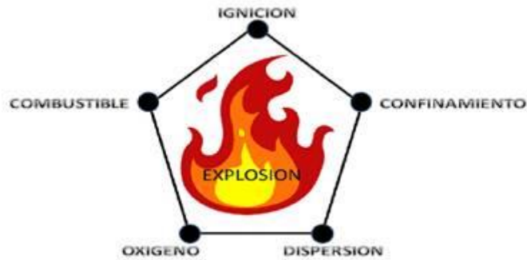
Figura 07- Pentágono de fuego y explosión de polvo. Papers Congreso- Prevención Integral- UTN-ORP
