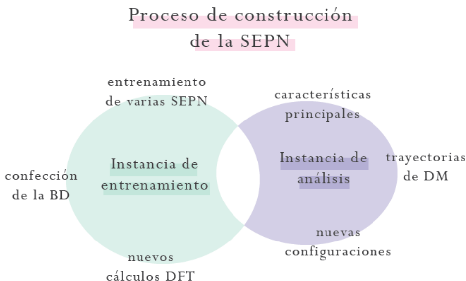
Figura 3.1 El ciclo implementado para la construcción de la SEPN consiste en dos grandes instancias, una de entrenamiento y otra de análisis de resultados. Durante la instancia de análisis se determina la calidad de las SEPNs que están siendo entrenadas mediante analizar principalmente el observable físico de convergencia: la PBA. Este ciclo se repite hasta que las propiedades físicas de la SEP para CO/Cu(110) son simuladas eficientemente.
