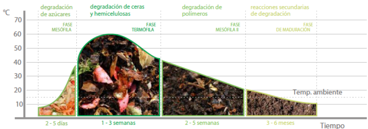
Figura 1. Proceso de compostaje. Fuente: "Compost Provincia de Santa Fe".
