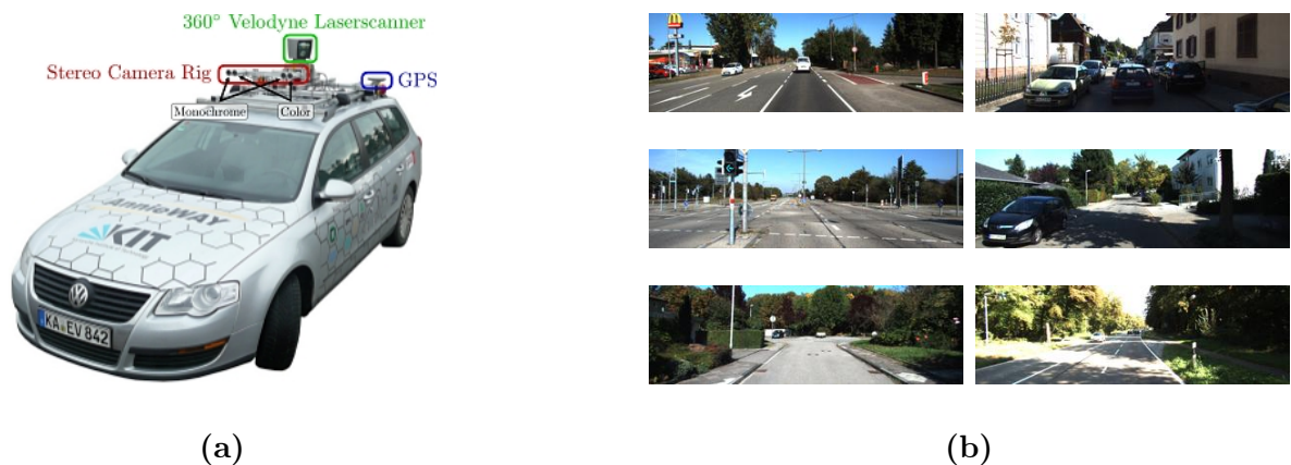
Figura 5.1.1: (a) Sensores utilizados en el dataset KITTI. (b) Imágenes pertenecientes a secuencias del dataset KITTI.
