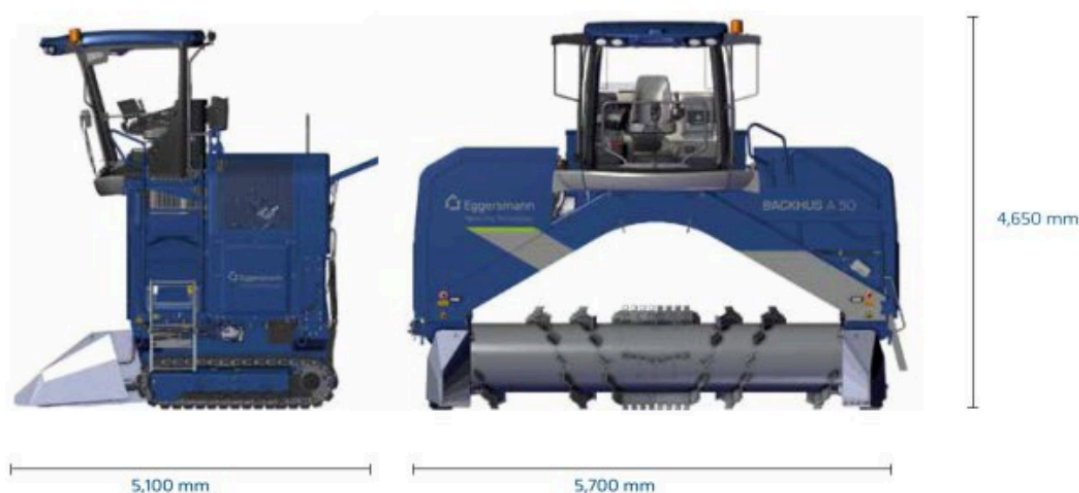
Figura 21. Dimensiones Backhus A50 en posición de trabajo. Fuente: www.eggersmann-recyclingtechnology.com .
