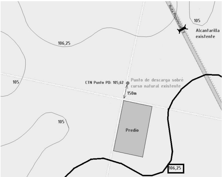
Figura 03: Identificación de la curva de nivel 106,25 y el punto PD
