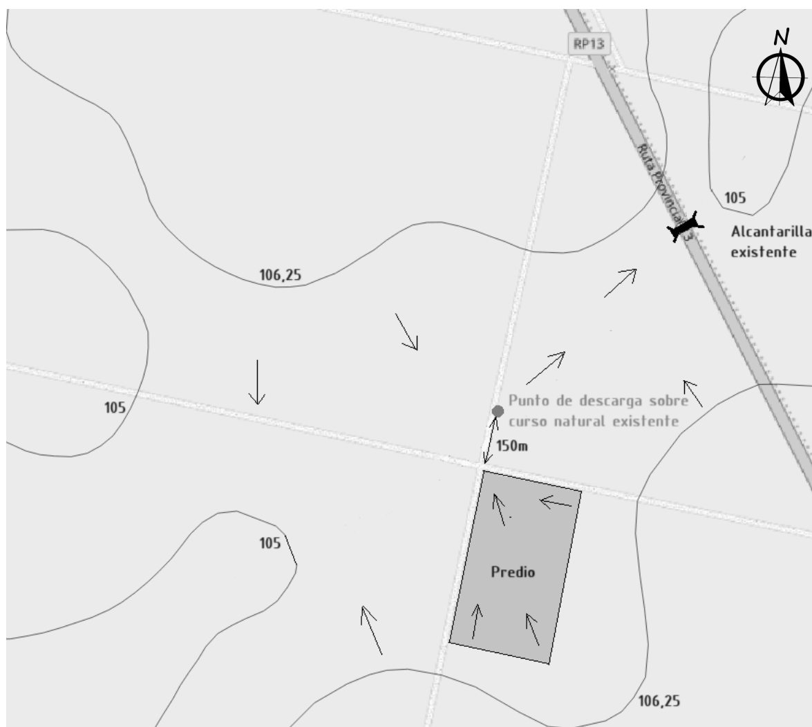
Figura 71. Escurrimiento zona de estudio. Fuente: elaboración propia.
