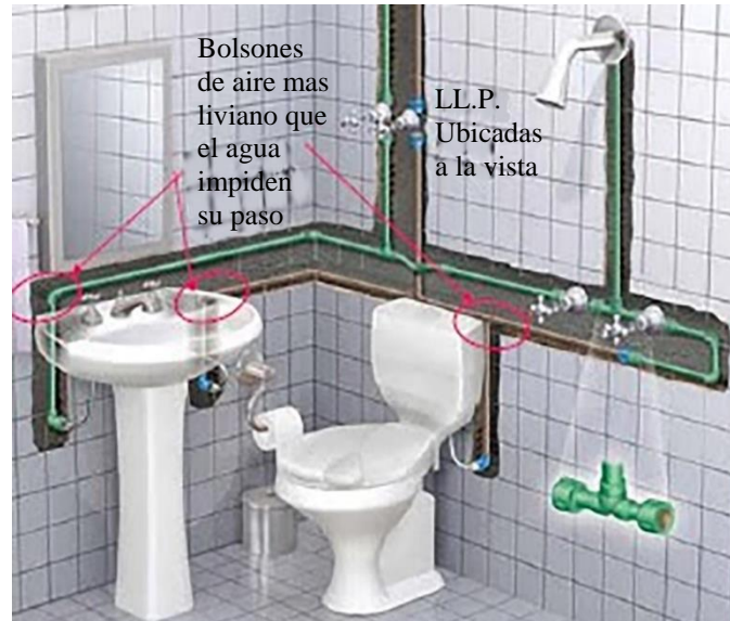
Ubicación incorrecta del tendido de cañerías
