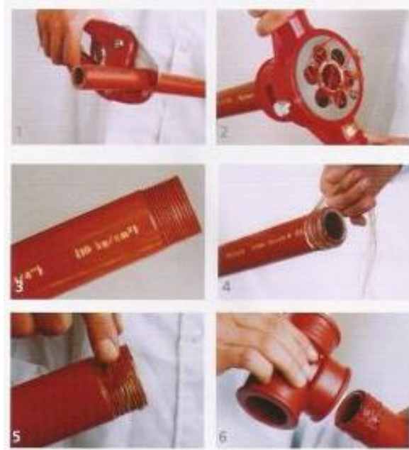
Ejemplo de unión roscada, para caños de PPP
