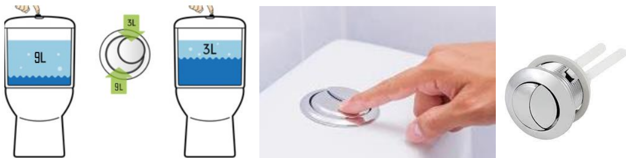
Detalle de accionamiento de mochila de doble descarga
