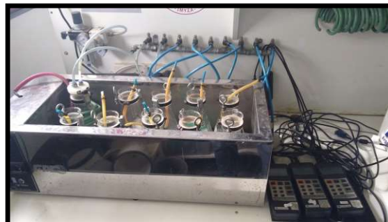
Foto 15: Equipo de respiración estática utilizado para medir el consumo de oxígeno
