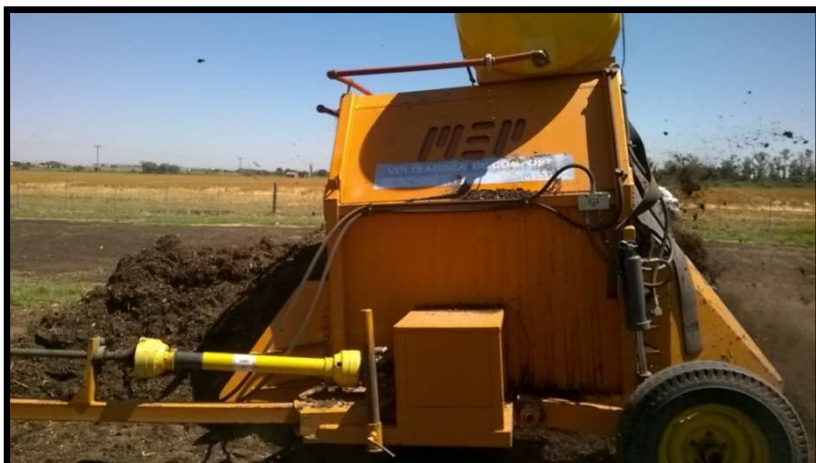
Foto 7: Removedora de compost sobre pila de compostaje
