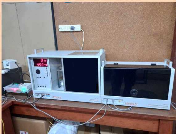
(d) Vista del equipo de rayos X con el módulo de tomografía computada
