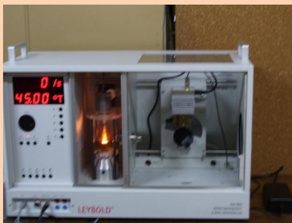
(c) Equipo de rayos X en configuración para la medida de fluorescencia
