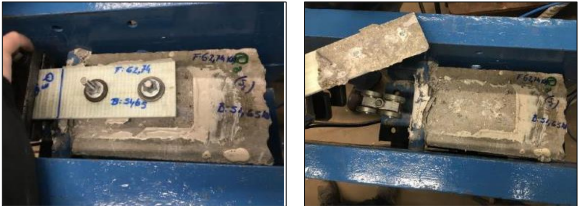
Figura 5.35 - Tipología de falla FH - Probeta Q3.
