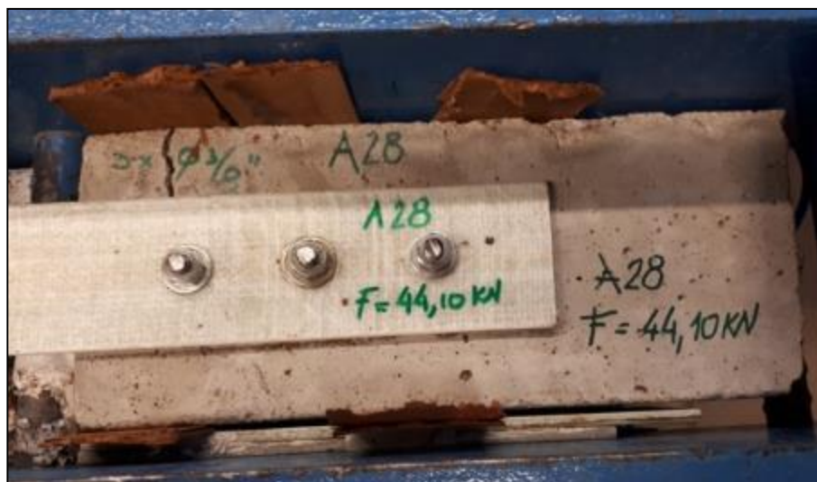
Figura 5.47 - Tipología de falla - Rotura del H° en correspondencia 1° bulón - Probeta A28.
