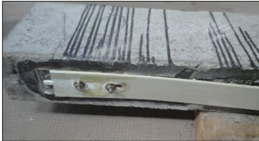
Figura 4.7 - Ojalamiento de los pernos de la V2 (2db10).
