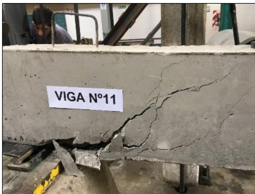
Figura 4.9 - Detalle rotura de apoyo V11 (2db8).
