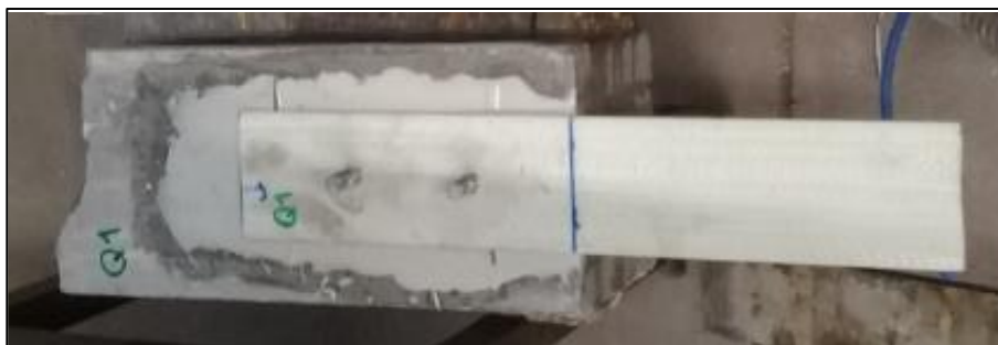
Figura 5.23 - Probeta con lámina pegada y anclada con dos bulones.
