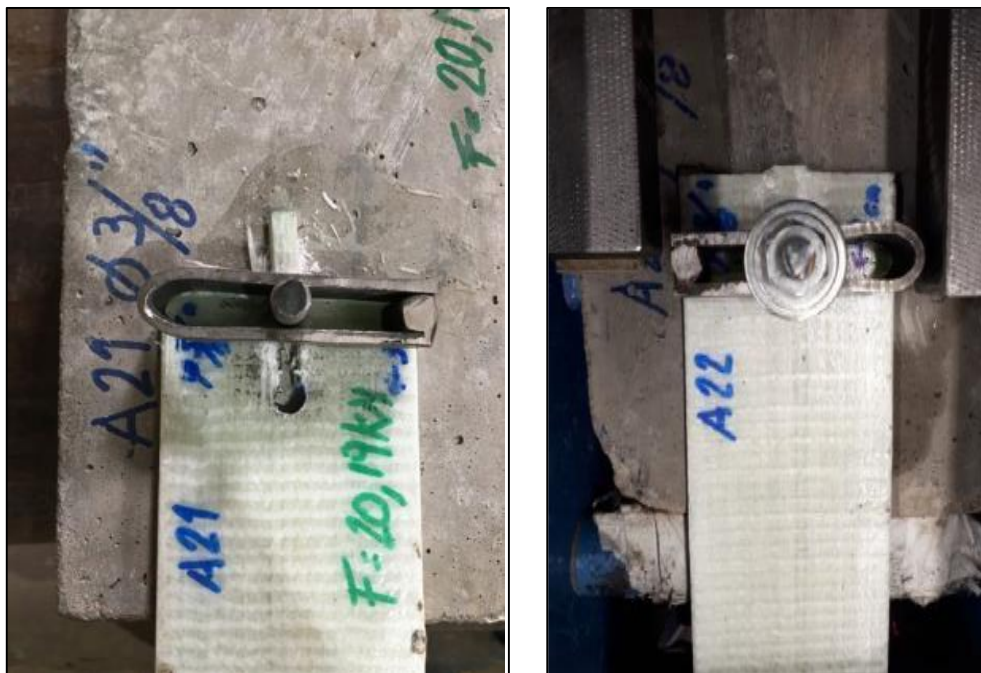
Figura 5.41 - Tipología de falla - Ojalamiento y Desgarramiento fibras - Probeta A21 y A22.
