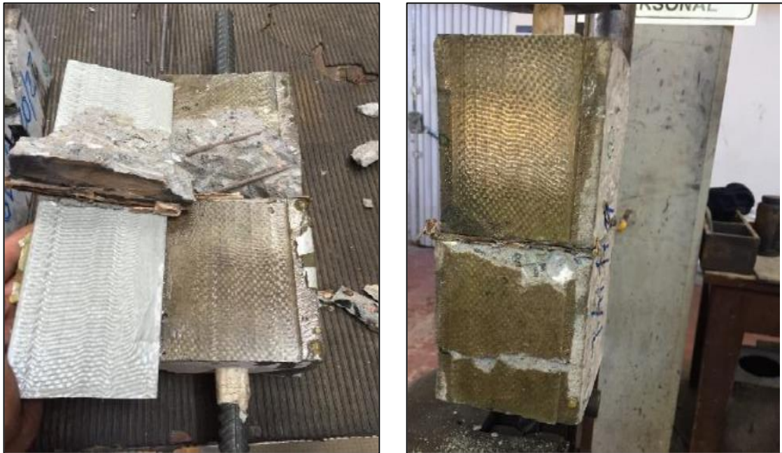
Figura 5.10 - Desprendimiento de la lámina y rotura de probeta
