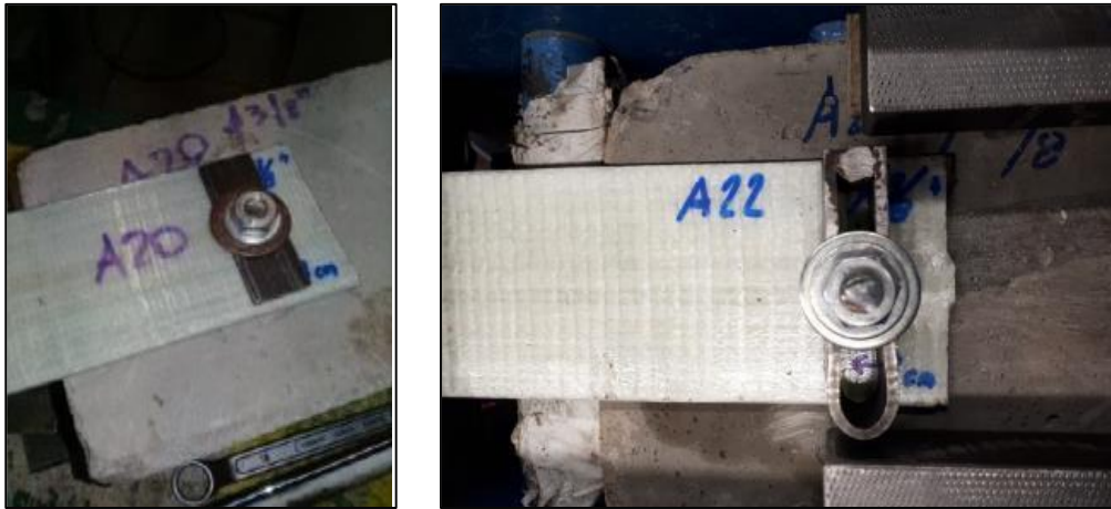
Figura 5.24 - Diferentes probetas con láminas ancladas con un bulón con chapas de distribución.
