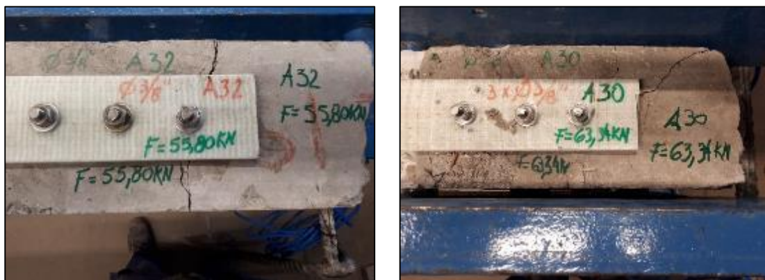
Figura 5.27 - Probetas con láminas ancladas con 3 bulones.
