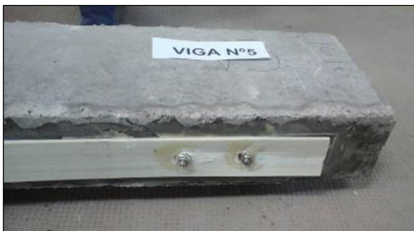
Figura 4.4 - Liger ojalamiento de los pernos de la V5 (2db12).
