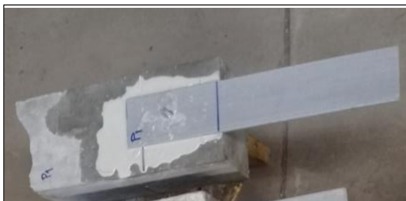
Figura 5.22 - Probeta con lámina pegada y anclada con un bulón.
