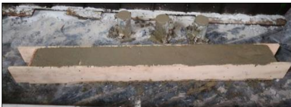
Figura 5.18 - Encofrado hormigonado de probetas armadas.
