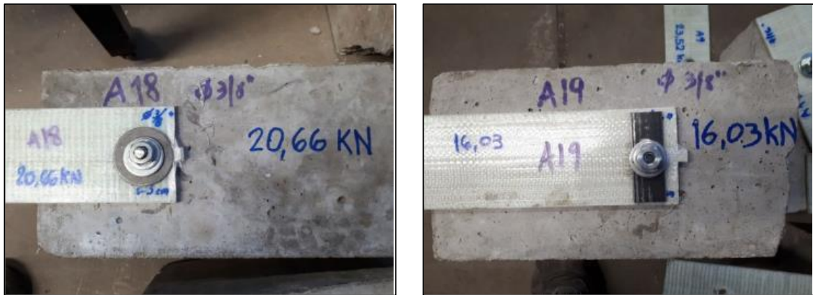
Figura 5.40 - Tipología de falla - Desgarramiento fibras - Probeta A18 y A19.
