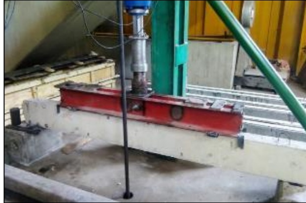
Figura 4.19 - Puesta a punto de la máquina de ensayo con viga sin refuerzo.
