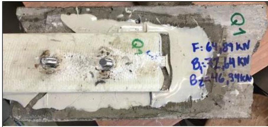
Figura 5.34 - Tipología de falla FH - Probeta Q1.
