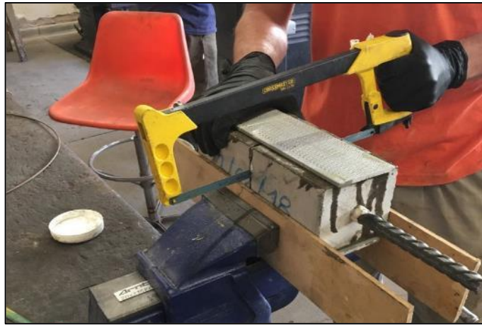
Figura 5.8 - Cortado de barra de acero
