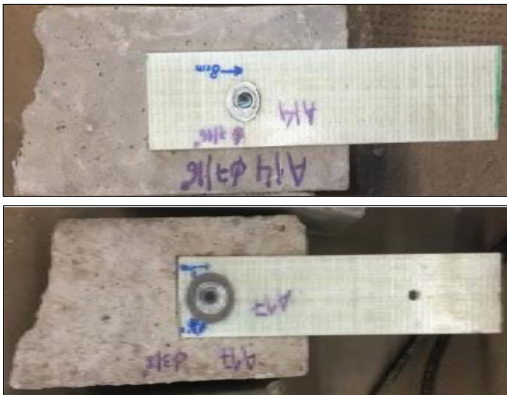
Figura 5.25 - Diferentes probetas con láminas ancladas con un bulón y arandelas de mayor diámetro.
