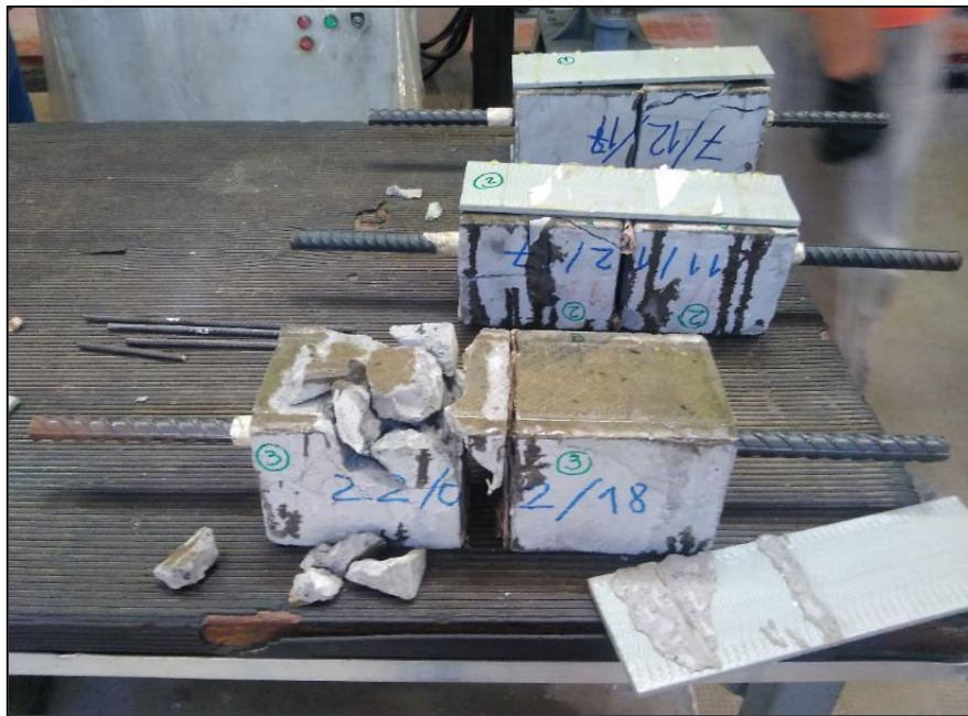
Figura 5.12 - Desprendimiento de la lámina más rotura del hormigón
