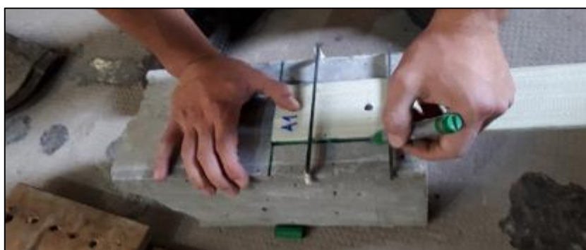
Figura 5.19 - Guías plásticas para el centrado de la lámina pultruída.
