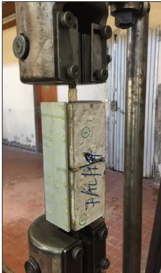
Figura 5.9 - Dispositivo de ensayo tracción centrada
