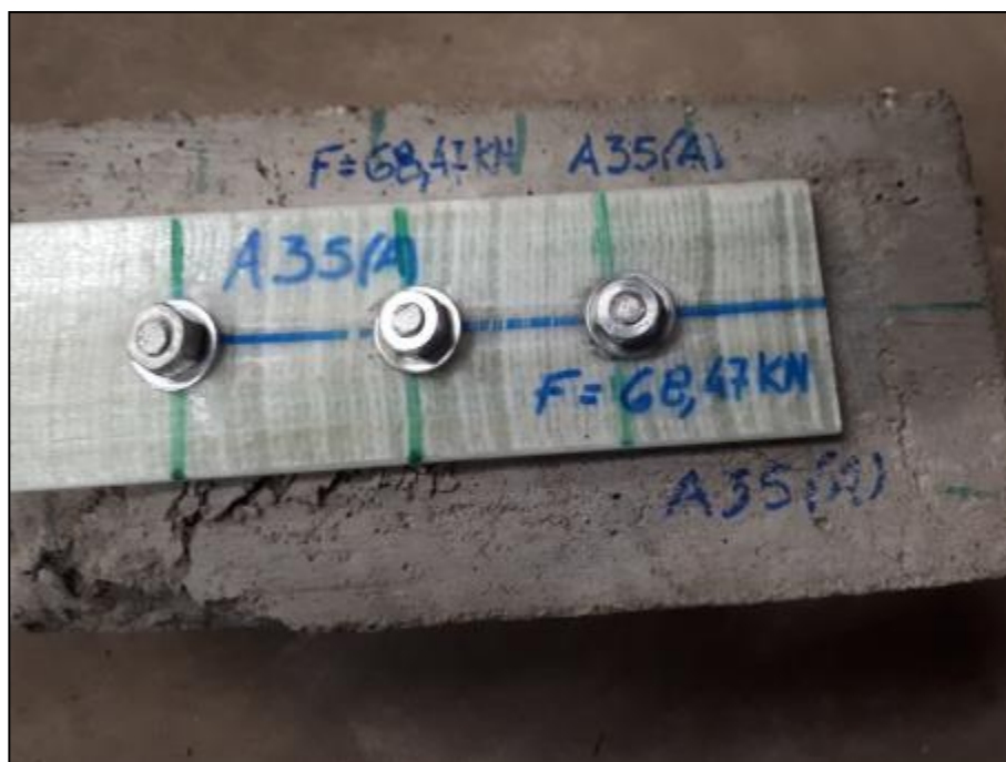
Figura 5.52 - Tipología de falla - Rotura H° - Probeta A35(A).
