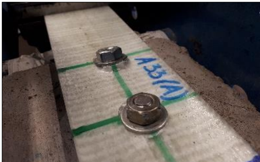
Figura 5.28 - Probetas de hormigón armado con láminas ancladas con 2 bulones.
