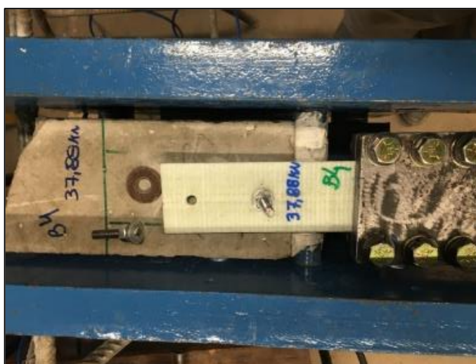
Figura 5.43 - Tipología de falla - Ojalamiento y desgarramiento fibras - Probeta B4.
