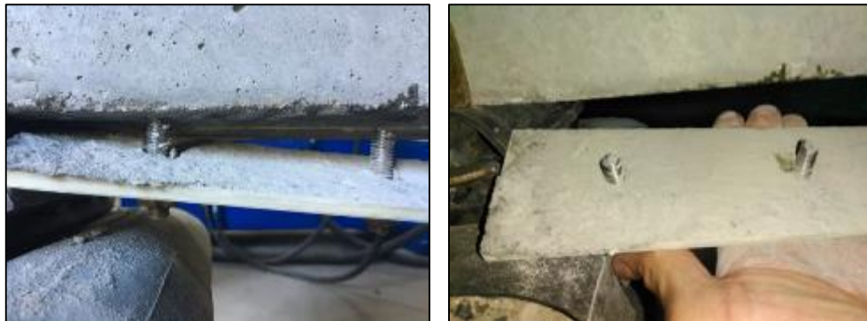
Figura 4.25 - Corte de los bulones V1.
