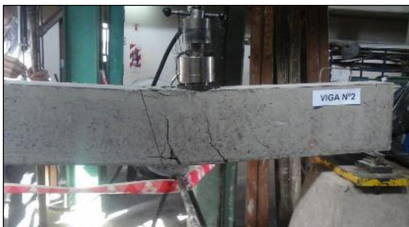
Figura 4-6 - Rotura V2 (2db10).
