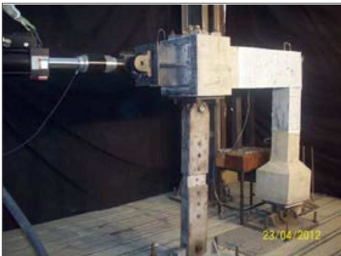
Figura 2.48 - Esquema de pórtico de ensayo [Vielma Pérez J.C y otros (2014)]
