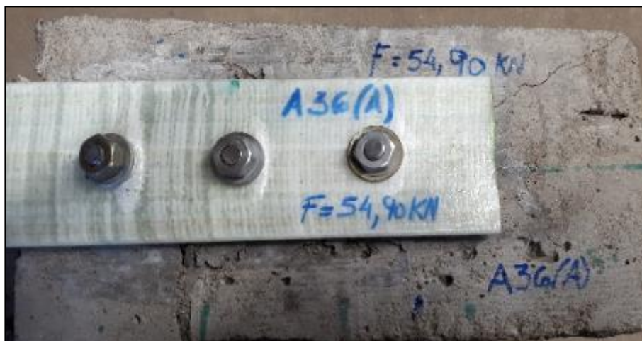
Figura 5.29 - Probetas de hormigón armado con láminas ancladas con 3 bulones.
