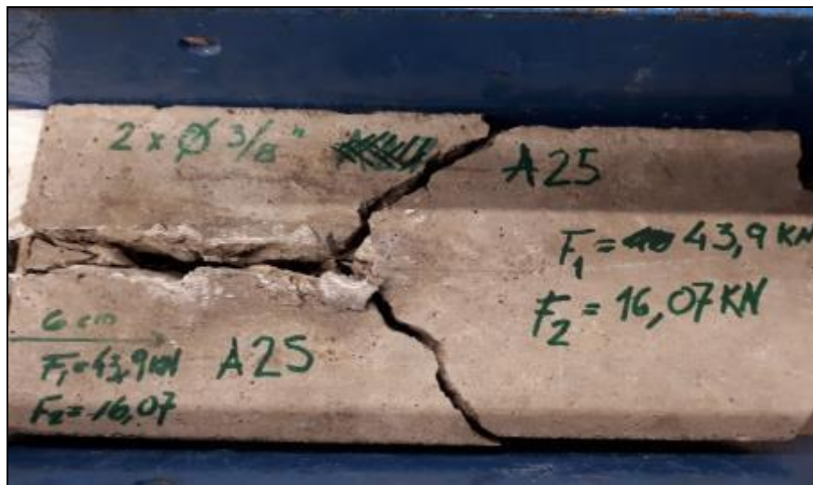
Figura 5.45 - Tipología de falla - Rotura de la probeta corte bulones - Probeta A25.
