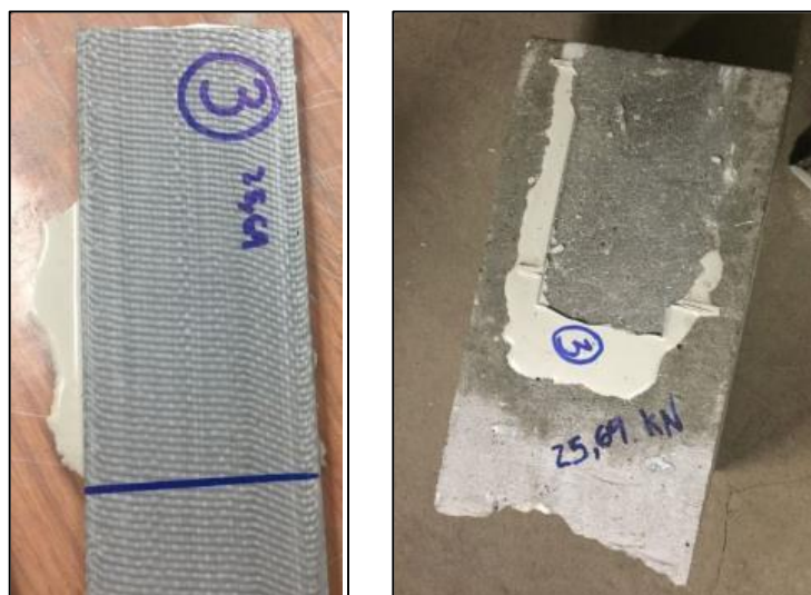
Figura 5.30 - Tipología de falla FH - Probeta 3.
