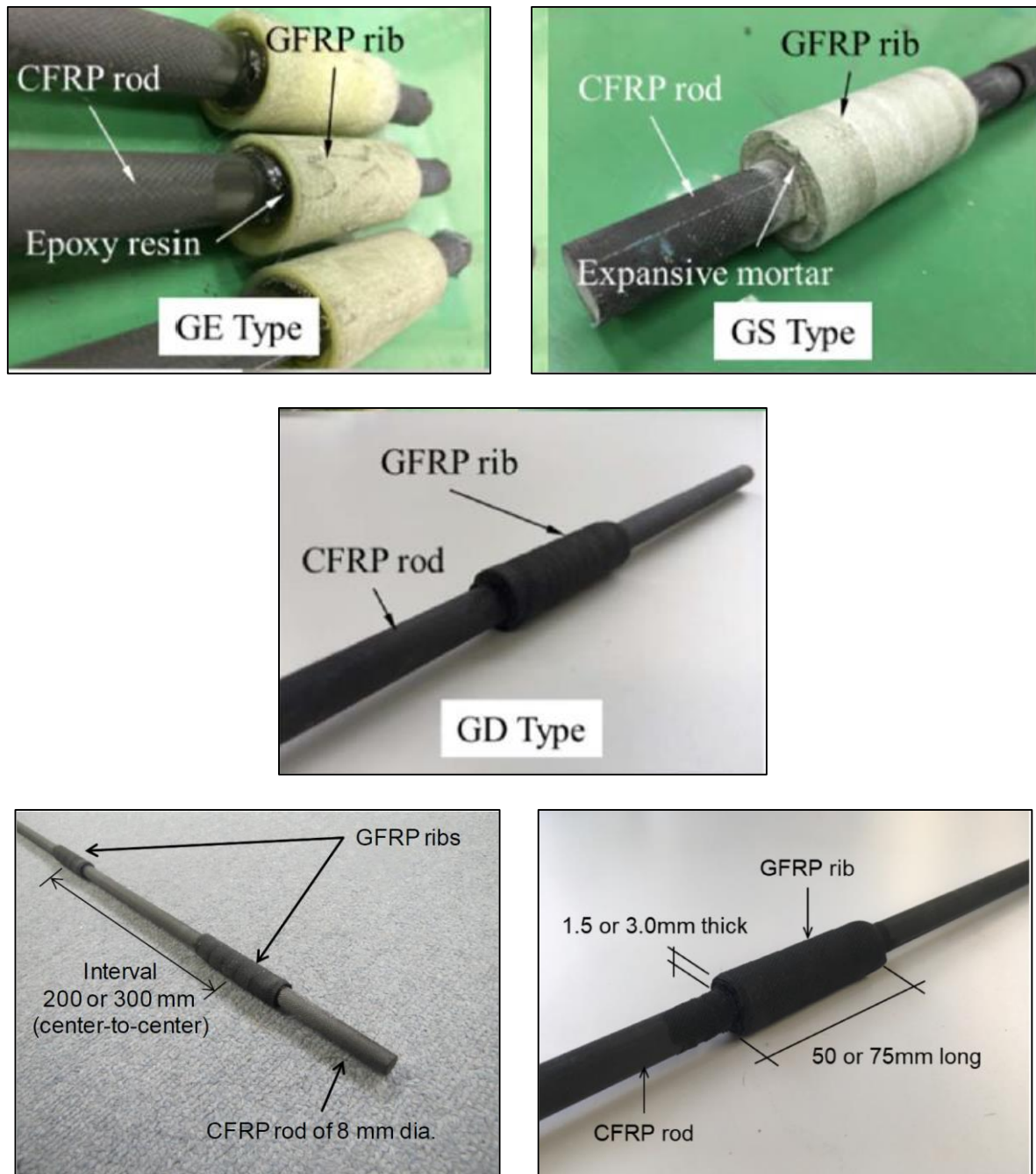
Figura 2.17 - Barras de CFRP con la adherencia mejorada a través de cintas de GFRP [Yoshitake, I., H. Hasegawa, K. Shimose (2020)] [Hasegawa H., I. Yoshitake, T. Kato (2020)]
