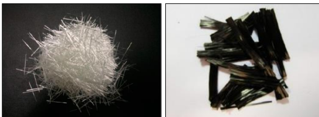
Figura 2.44 - Fibras de vidrio y de carbono cortadas utilizadas para los refuerzos [Lee K.S., B.Y. Lee, S.Y. Seo (2016)]
