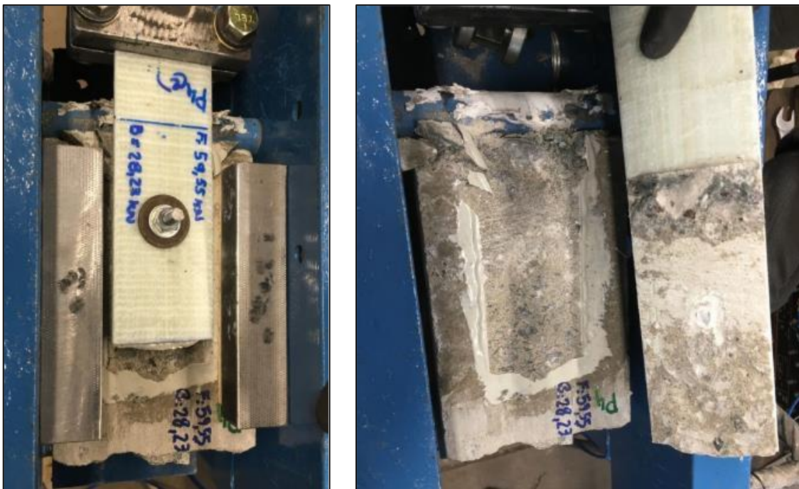
Figura 5.33 - Tipología de falla FH - Probeta P4.
