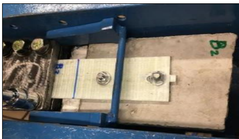
Figura 5.42 - Tipología de falla - Ojalamiento y desgarramiento fibras - Probeta B2.
