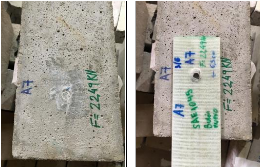
Figura 5.38 - Tipología de falla - Corte de bulón - Probeta A7.
