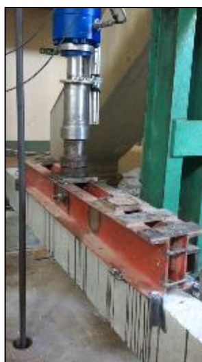
Figura 4.18 - Montaje de viga para ensayo a fatiga.
