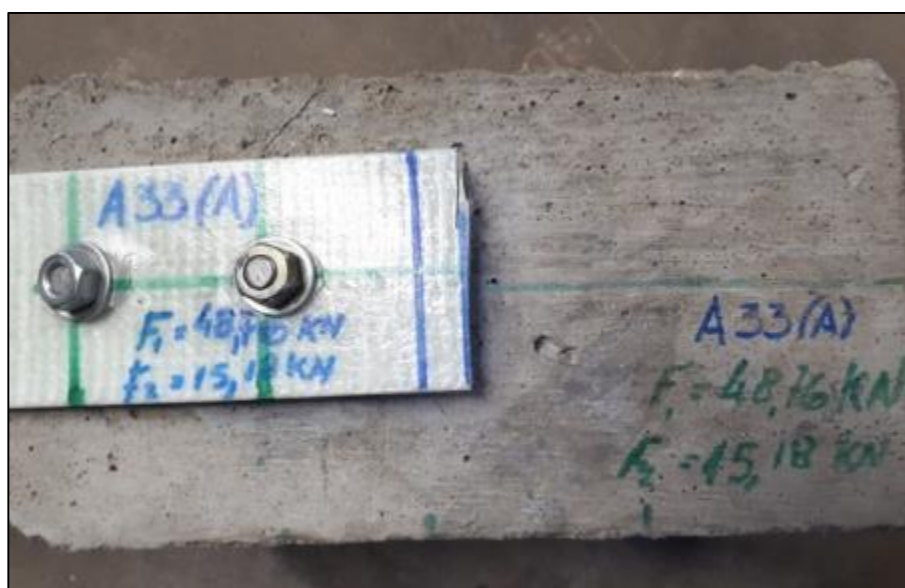
Figura 5.50 - Tipología de falla - Corte 1° bulón y Ojalamiento 2° bulón - Probeta A33(A).
