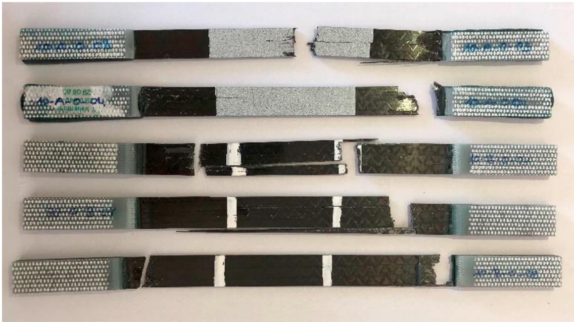
Figura 2.6 - Modos de falla para probetas de CFRP en pruebas de tracción estática [Eliasson S., S. Wanner, Z. Barsoum, P. Wennhage (2019)]
