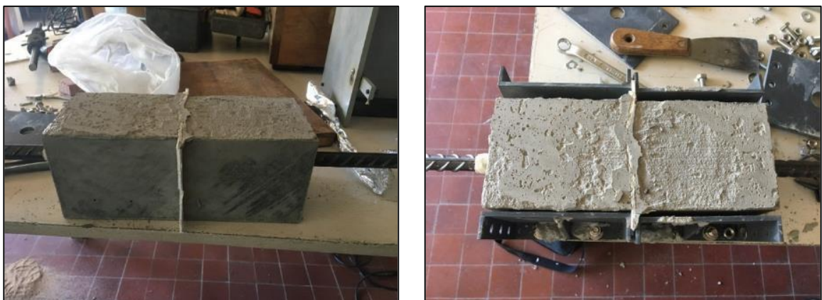
Figura 5.5 - Desencofrado de probeta
