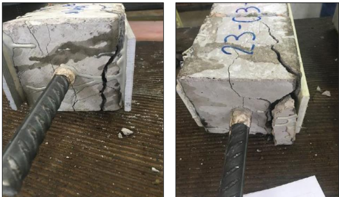
Figura 5.11 - Rotura del hormigón
