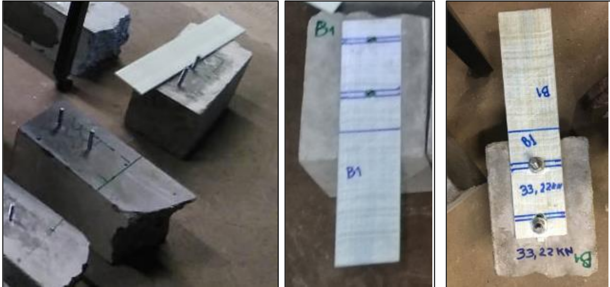
Figura 5.26 - Probetas con láminas ancladas con 2 bulones.
