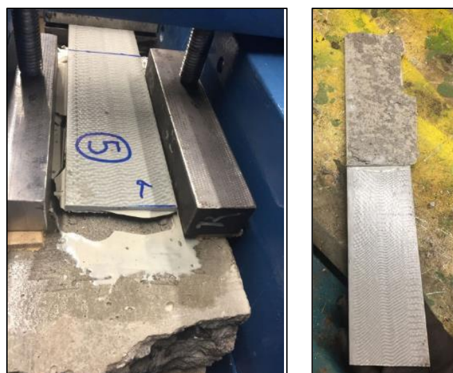
Figura 5.31 - Tipología de falla FH - Probeta 5.
