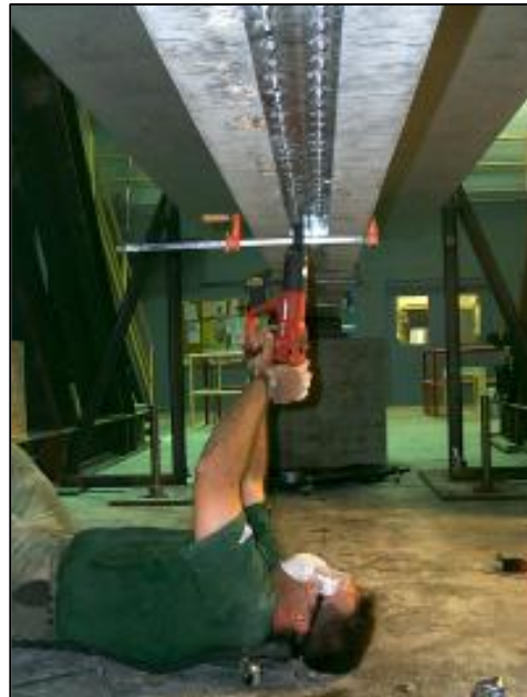
Figura 2.58 - Láminas Safstrip vinculadas mecánicamente [Lamanna A.J., L.C. Bank, D.T.Borowicz, D.Arora (2003)]
