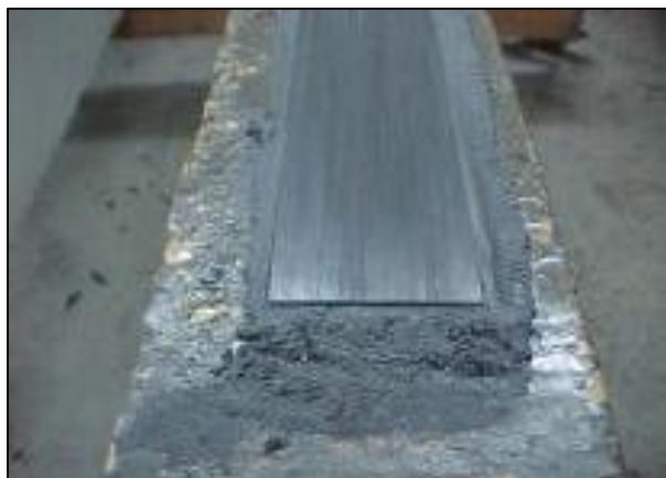
Figura 2.11 - Detalle del extremo de la lámina adherida [Esteves J.L., P. Vieira, A.T. Marques (2001)]
