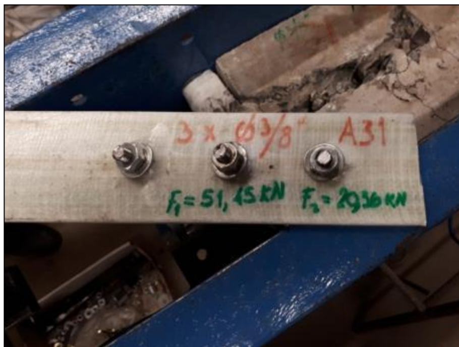
Figura 5.49 - Tipología de falla - Rotura de H° y Ojalamiento en los 3 bulones - Probeta A31
