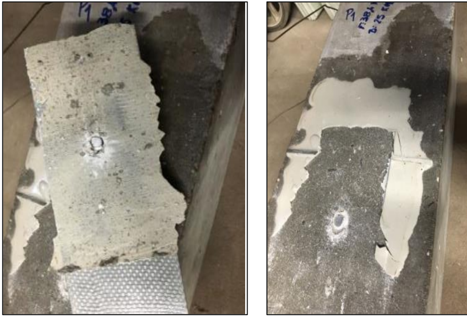
Figura 5.32 - Tipología de falla FH - Probeta P1.
