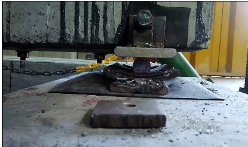
Figura 4.16 - Materialización del apoyo móvil.
