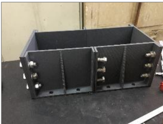
Figura 5.3 - Ensamblado de encofrados
