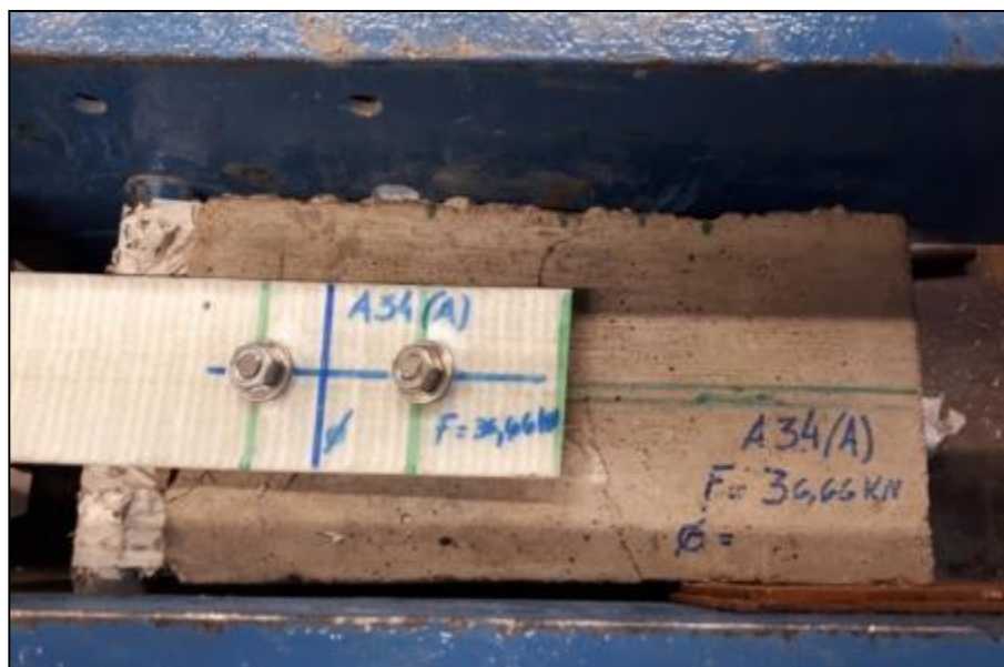
Figura 5.51 - Tipología de falla - Desprendimiento del H° - Probeta A34(A).
