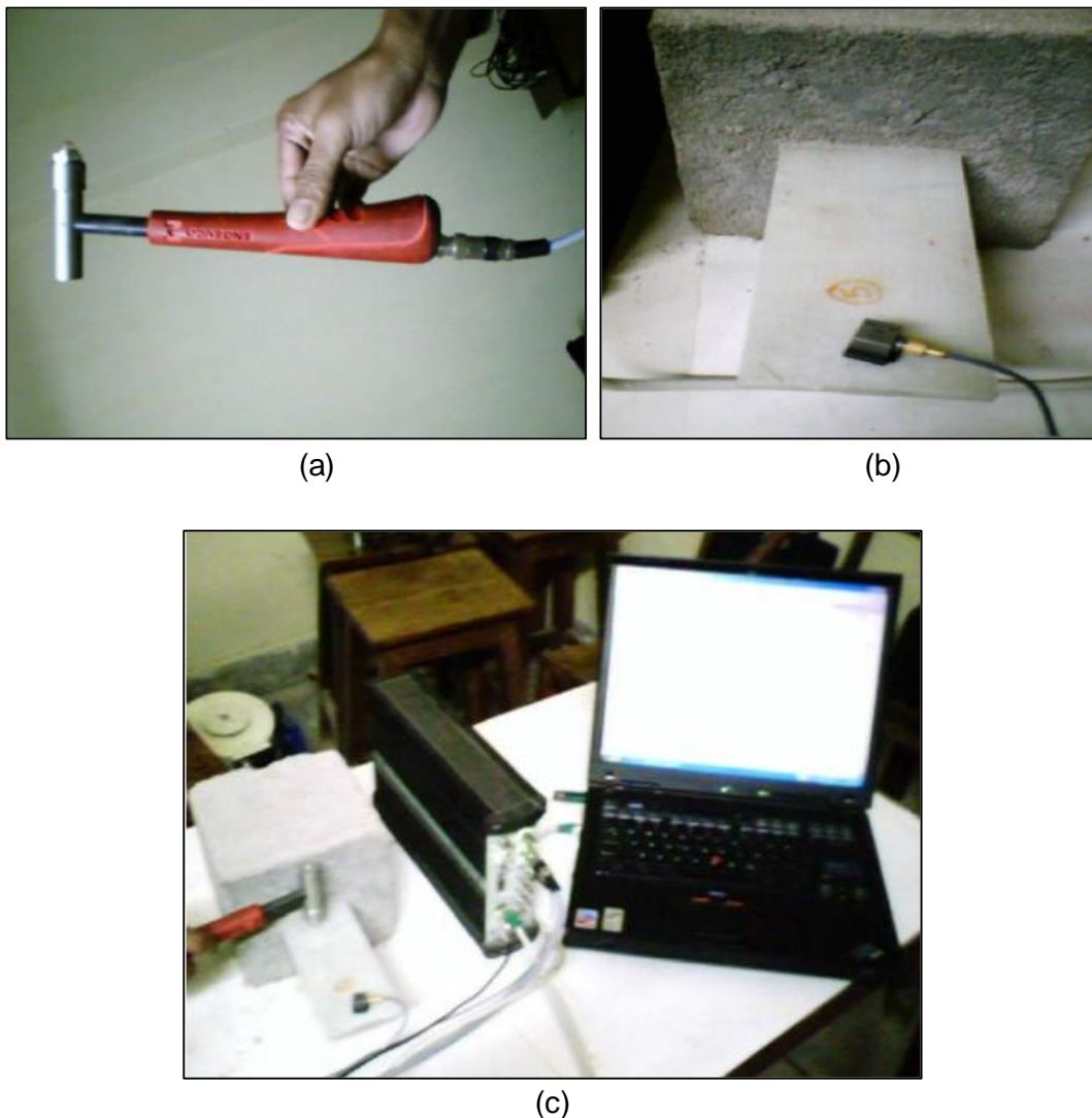
Figura 2.28 - (a) Martillo modal (b) Lámina en voladizo (c) Acelerómetro [Nayak P. (2008)]
