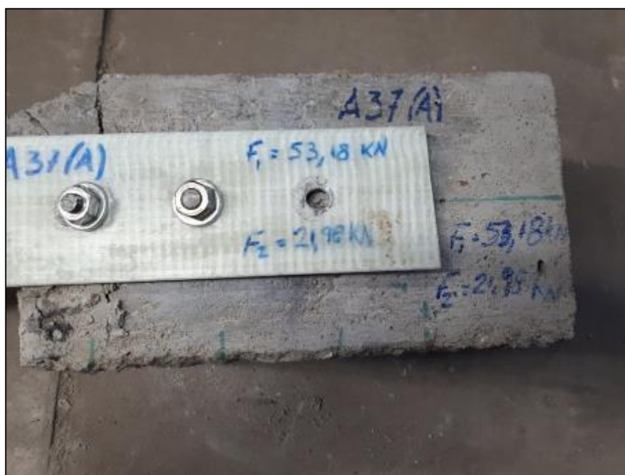
Figura 5.53 - Tipología de falla - Rotura H° y Corte del 3° bulón - Probeta A37(A).
