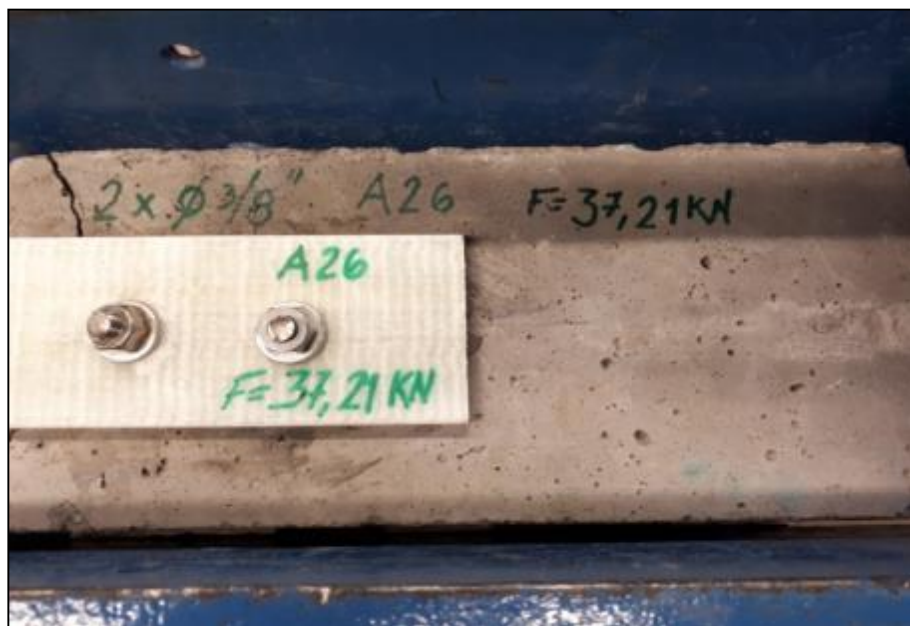
Figura 5.46 - Tipología de falla - Rotura de la probeta corte 1 bulón - Probeta A26
