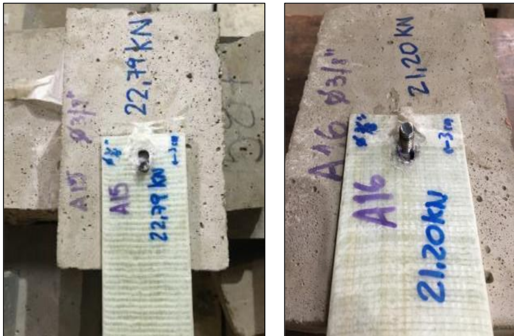
Figura 5.39 - Tipología de falla - Desgarramiento de fibras - Probeta A15 y A16.
