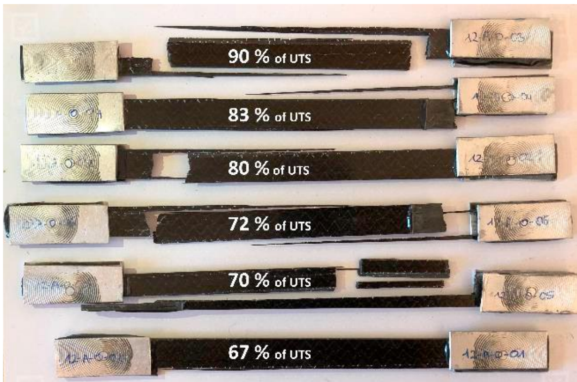
Figura 2.7 - Modos de falla para probetas de CFRP en pruebas de fatiga a diferentes porcentajes de UTS (Ultimate Tensile Strength), con R = 0.1 y f = 5 Hz [Eliasson S., S. Wanner, Z. Barsoum, P. Wennhage (2019)]
