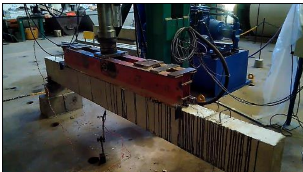
Figura 4.26 - Ensayo a fatiga V2.
