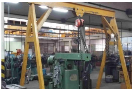
Figura 43: Aparejo tipo pórtico a cadena en taller de máquinas herramienta Fuente:Elaboración Propia
