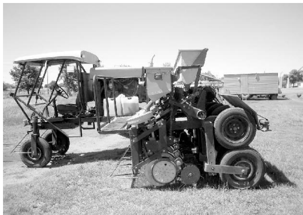
Vista lateral de la Intersembradora
