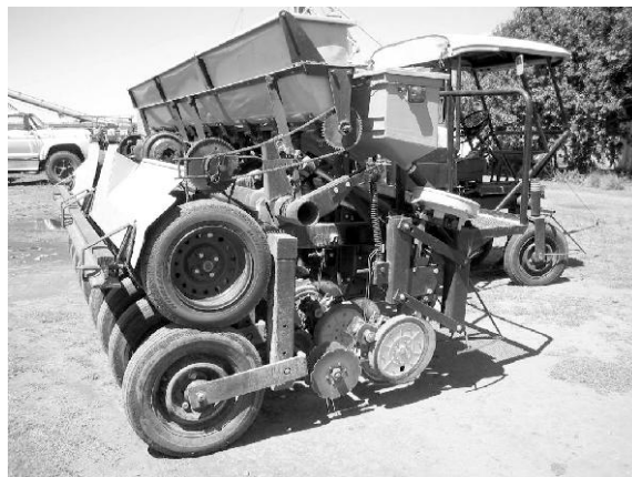
Vista lateral del tren de siembra de la Intersembradora
