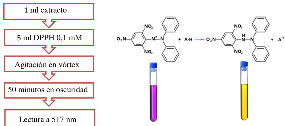
Figura 4.15. Diagrama del método de determinación de la capacidad antioxidante de los extractos de harina de quinoa.
