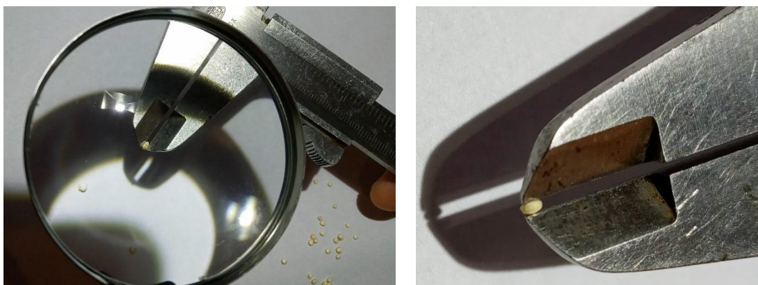
Figura 4.2. Mediciones del largo, ancho y espesor del grano de quinoa.
