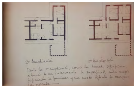
Prototipo de vivienda proyectado por el EEV. Proceso constructivo. Fuente: Equipo de Estudio de la Vivienda. Viviendas de realojamiento. Publicación de una experiencia . Rosario. 1964
