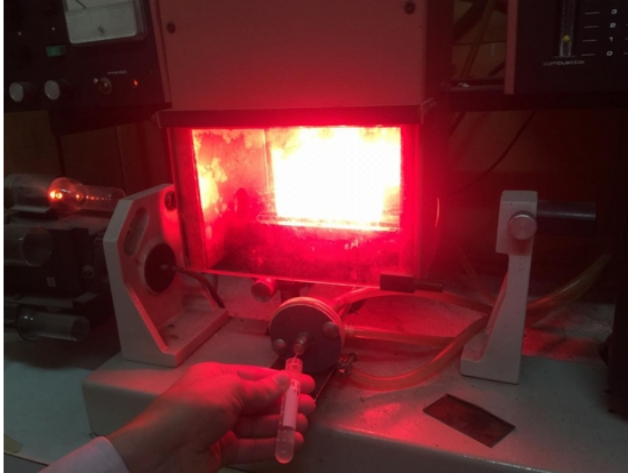
Figura 20.2. Volatilización de la muestra en la llama del espectrofotómetro de absorción atómica. El color rosa intenso se debe al \text{SrCl}_2 agregado para evitar interferencias de algunos iones.
