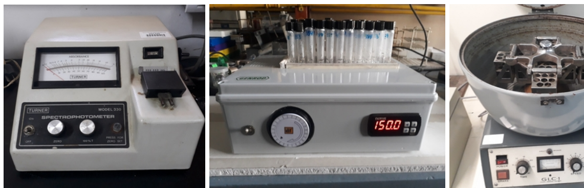
Figura 2. A la izquierda espectrofotómetro Turner, en la imagen central la platina de calentamiento, y a la derecha una centrifuga.
