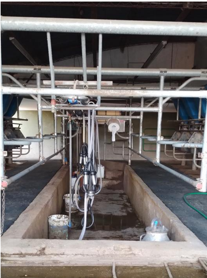
Figura 14: Sala de ordeño, con un sistema de ordeño en espina de pescado con seis (6) bajadas.
